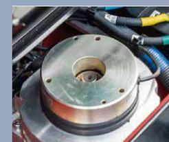
Sistema de freno de estacionamiento eléctrico (EPB)
