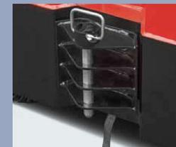
Con un diseño especial, el dispositivo de tracción puede evitar que el pasador de remolque se salga durante el desplazamiento
