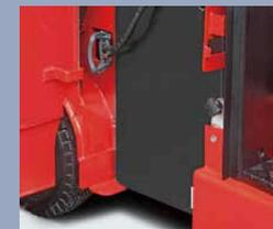
La batería se puede extraer del lateral del carro elevador, lo que resulta muy práctico para el mantenimiento de la batería
