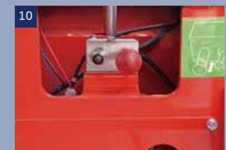
Válvula de liberación manual: cuando la máquina no se puede mover, puede empujarla después de presionar esta válvula
