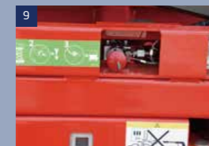
Válvula de bajada manual: cuando el sistema operativo falla o la carga de la batería es demasiado baja para que la plataforma disminuya, podemos usar esta válvula para bajar la máquina
