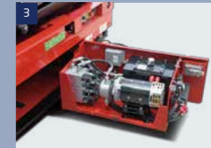
Sistema hidráulico y eléctrico
