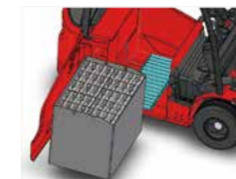
Desalojo lateral de la batería mediante rodillo (opcional)
